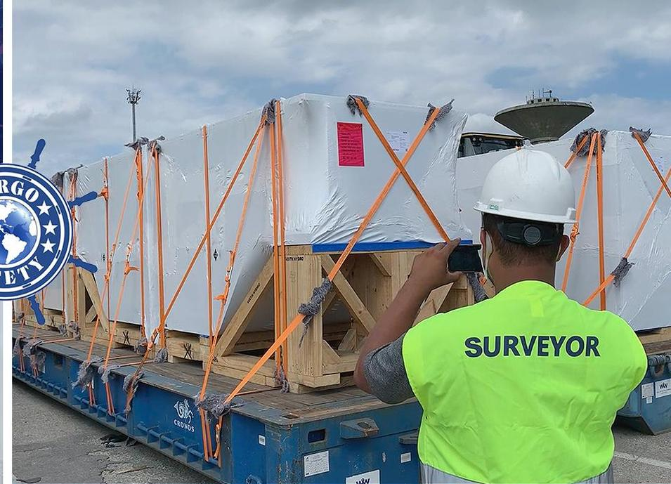
Nosso Surveyor atesta a resistência dos materiais, sua distribuição de peso, condições do suporte das unidades de carga, condições dos cabos, fitas, correntes, ferragens e dimensões das embalagens.
