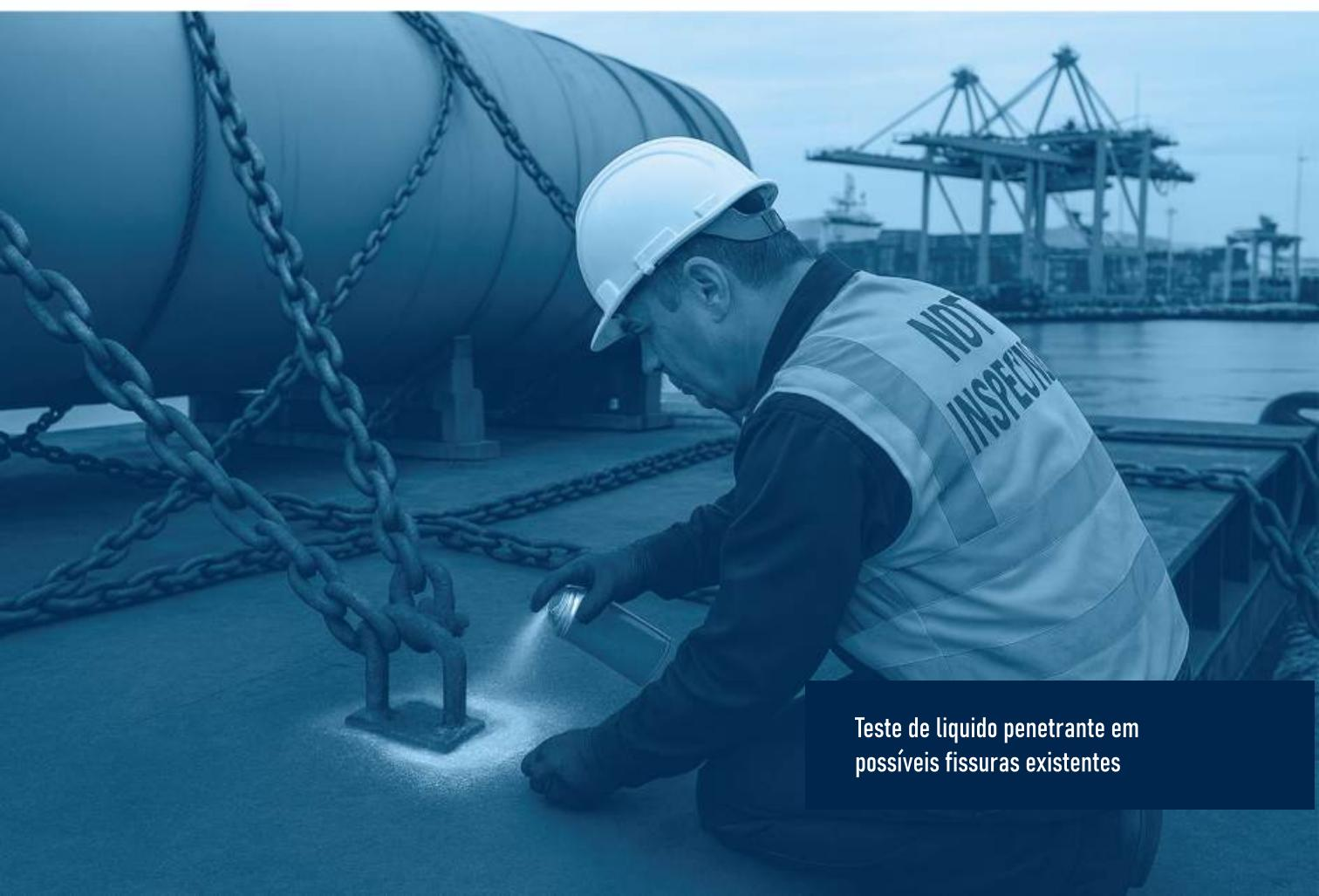
Teste de líquido penetrante em possíveis fissuras existentes
